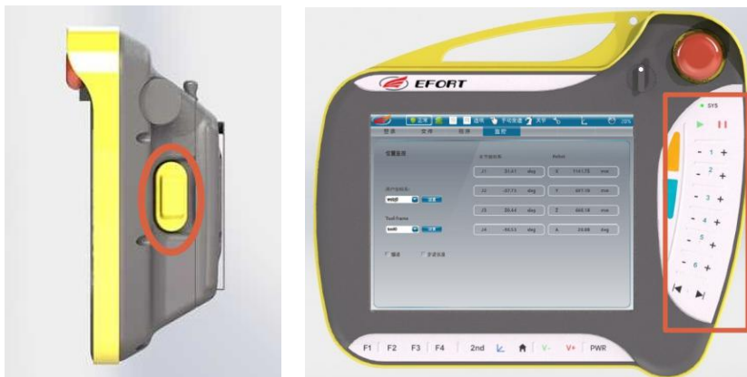
图 4-9 示教器手压及右侧功能键
