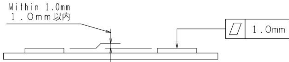
图 2-8 机器人安装面精度
