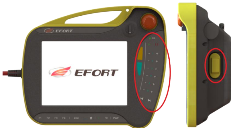
图 4-8 示教器手压及右侧功能键
