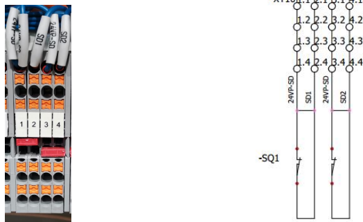
图 3-7 安全门及光栅接线端子示意
