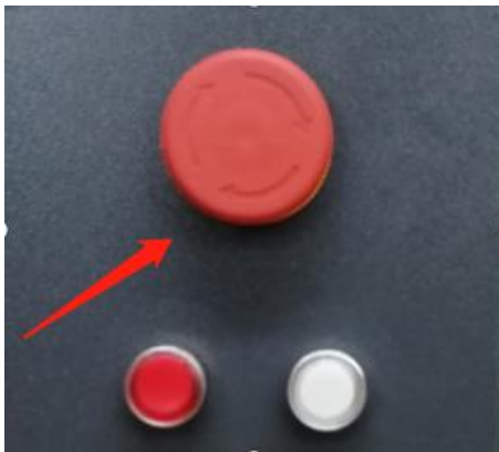
图 4-11 检查急停开关
