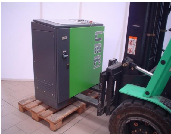
图 2-2 用叉车移动电柜
