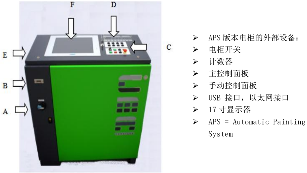
图 3-2 电柜外形图 (APS 版本)
